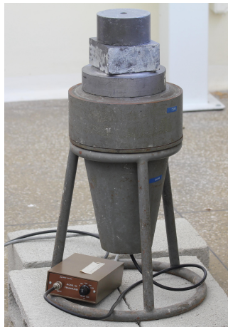
Figura 3.7 – Geometria para a medição experimental da fonte ^{241}\text{Am}
