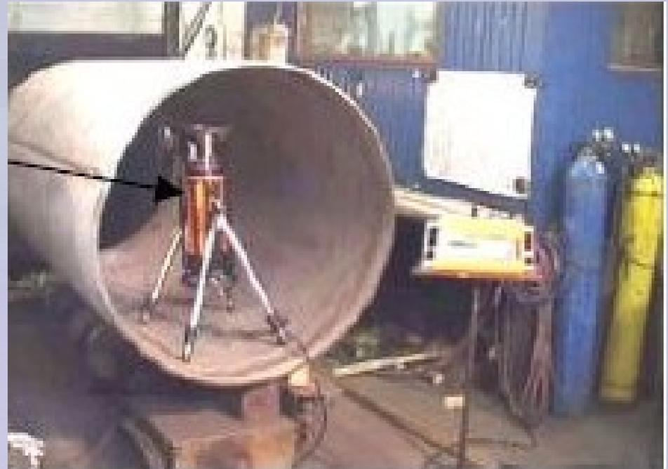
Inspeção radiográfica de soldas em tubos
