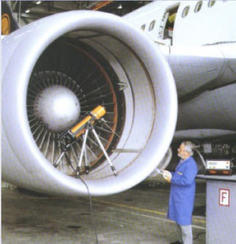
Ensaio Radiográfico da Turbina de um avião
