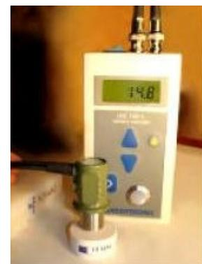
Figura IV-09: Medidor de espessura digital ultrassônico
