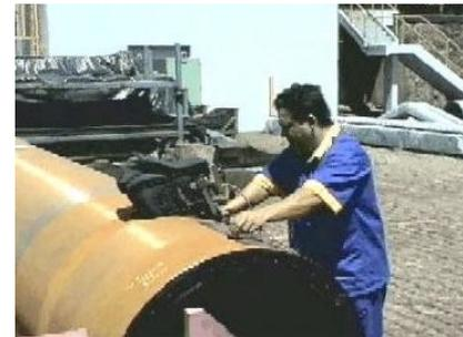
**Figura IV-02: Inspeção por ultra-som da chapa de um tubo**
