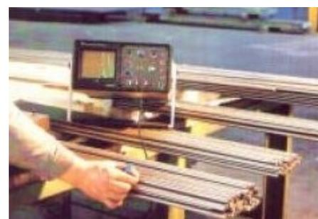
Figura IV-04: Inspeção de barras pela técnica pulso-eco por contato direto, usando transdutor normal de 12mm de diâmetro.
