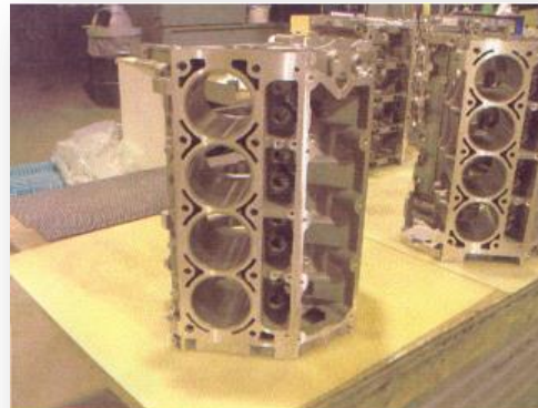
Inspeção de bloco de motores – Fase de limpeza
