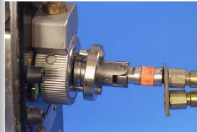
Operação de conexão da fonte de Ir-192 - Fase 4 (final)
