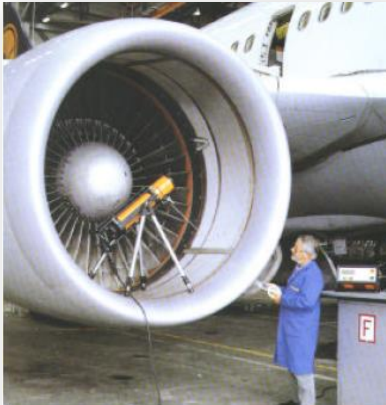
Ensaio Radiográfico da Turbina de um avião
