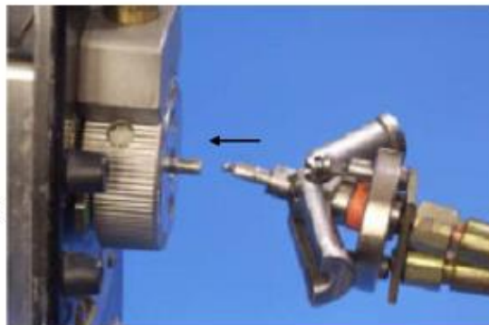
Operação de conexão da fonte de Ir-192 - Fase 1
