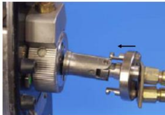
Operação de conexão da fonte de Ir-192 - Fase 3
