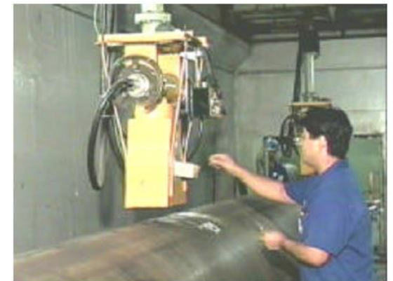
Inspeção radiográfica de soldas em tubos
