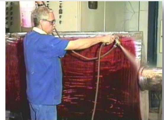
Foto: gentileza de VOITH SIEMENS Remoção com spray de água
