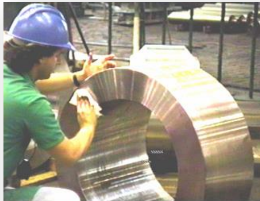
Remoção do penetrante com pano
