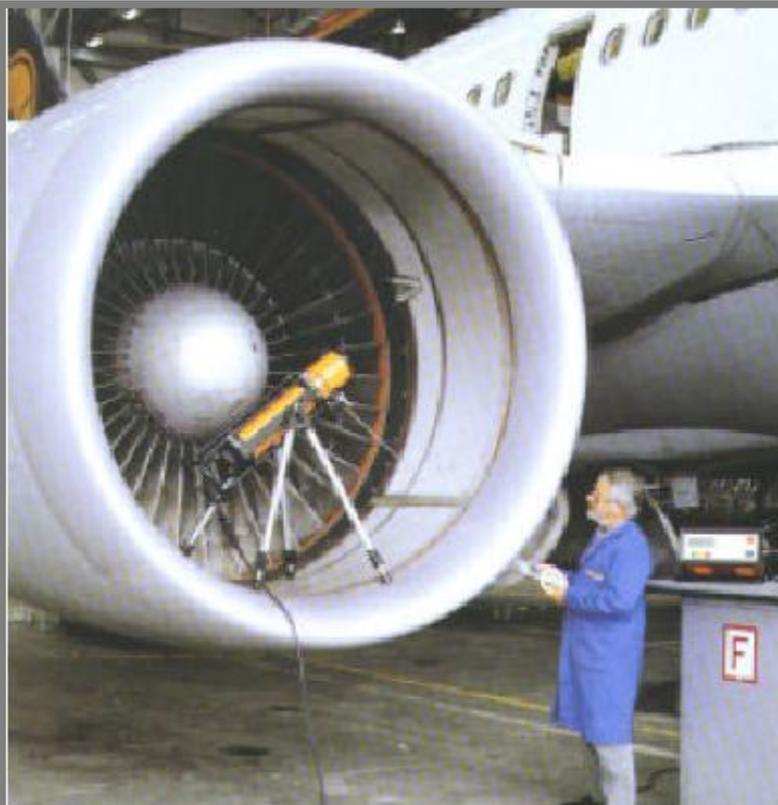
Ensaio Radiográfico da Turbina de um avião
