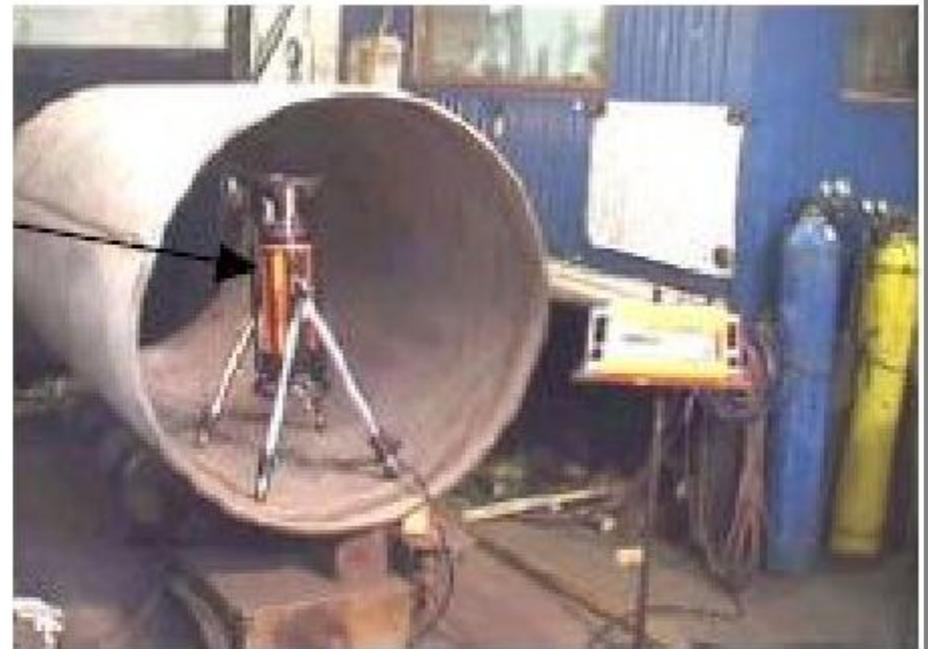
Inspeção radiográfica de soldas em tubos
